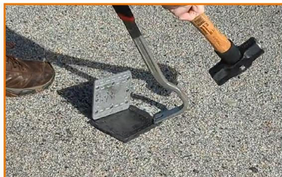
1. Placez un pied-de-biche métallique contre un coin du capteur RoadPod VM. La pointe du pied-de-biche doit être placée entre le boîtier métallique du capteur VM et le tampon adhésif.
