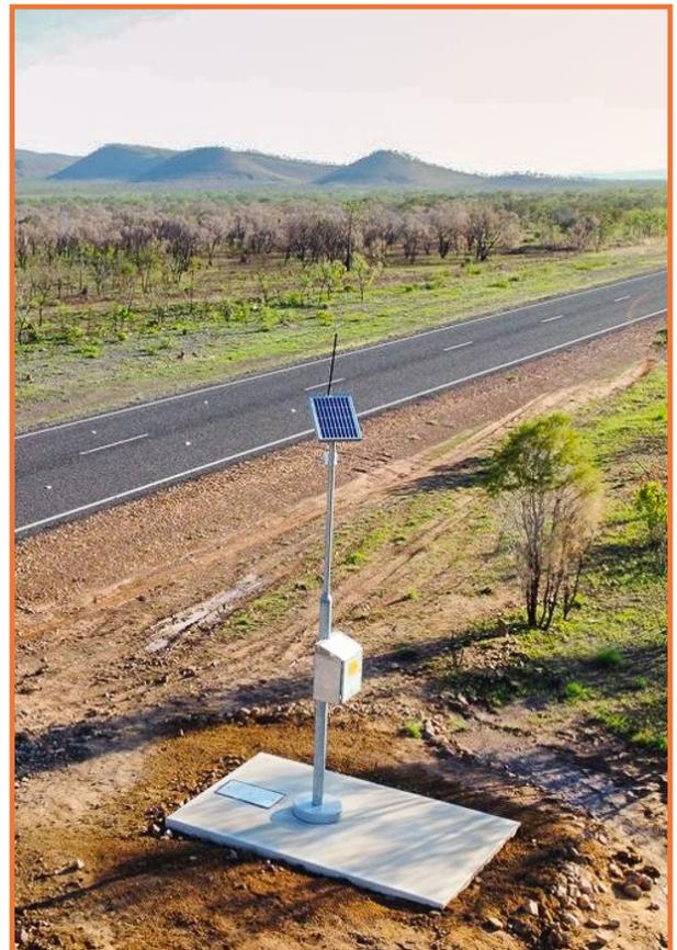
Poteau, panneau solaire et armoire abritant le RTG fournis par le client
