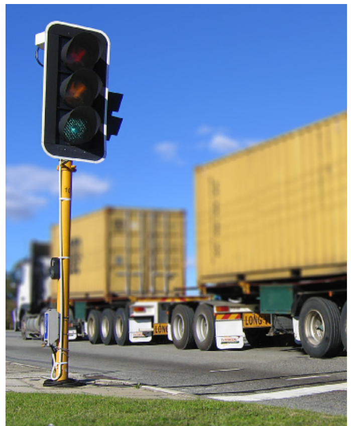
Il RoadPod® PhaseT registra dati sincronizzati alle fasi dei semafori utilizzando tubi pneumatici e fibre ottiche.
