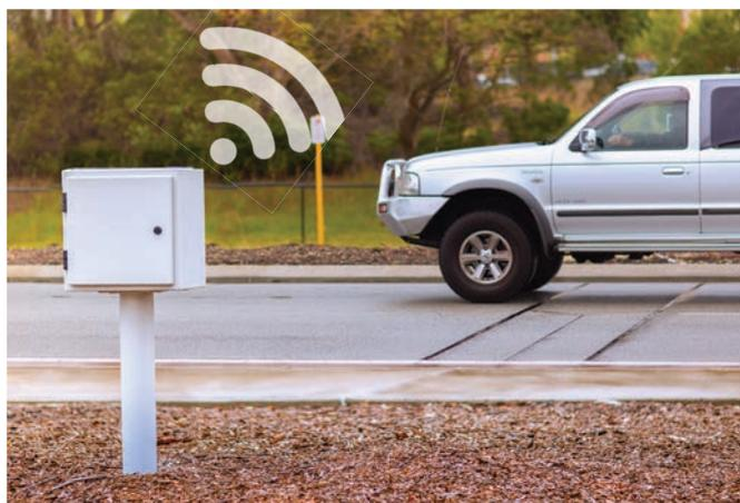
*La caja de carretera incluye un panel solar, una batería de reserva y un módem que transmite los datos de forma segura remotamente.*
